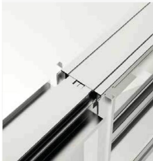
2. Передній профіль. Передні профілі пеналу є зміцнені додатковими ребрами, щоб забезпечити конструкцію від випадкового прогину.
